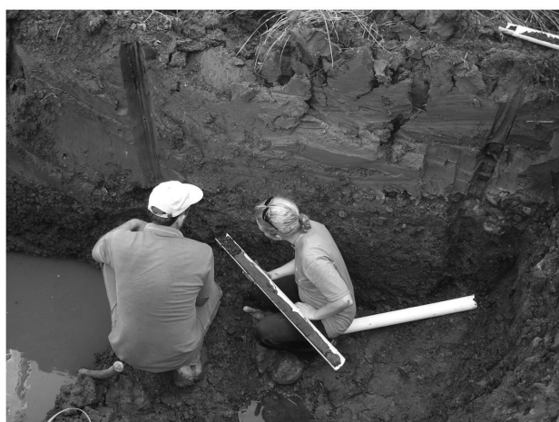
FIGURA 6 - Coleta utilizando tubos de PVC cortados ao meio (AS)
