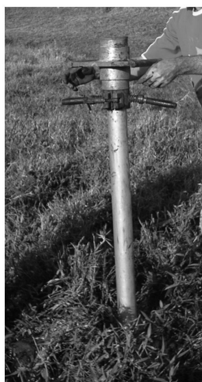
FIGURA 7 - Coleta utilizando tubos de alumínio e batente (Irai)
