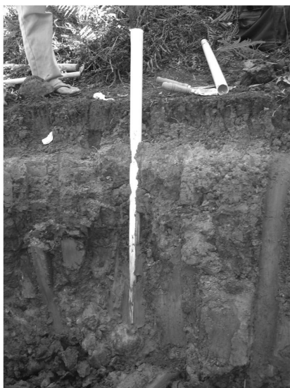
FIGURA 2 - Coleta utilizando tubos de PVC inteiros (Ametista do Sul - AS)
