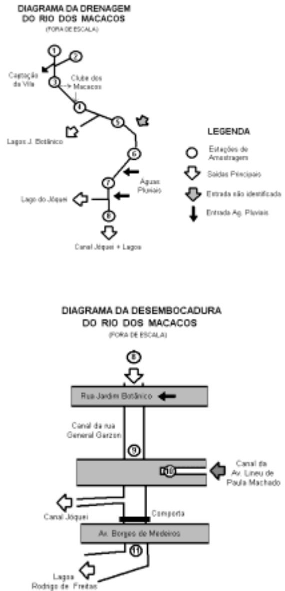
Figura 01 - Diagrama esquemático do Rio dos Macacos mostrando as principais entradas e saídas de água do sistema e as estações de amostragem. O diagrama de cima apresenta as estações 1 a 8 e o de baixo apresenta as estações 9, 10 e 11.
